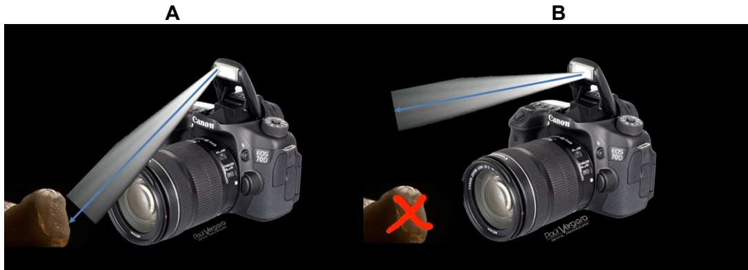
Figura 43. A: Cómo debería llegar la luz del flash integrado al objeto a fotografiar. B: La dirección de luz que realmente llega al objeto a iluminar con el flash integrado.
