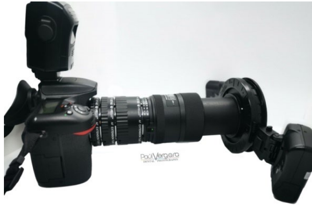
Figura 28. Tubos de extensión y objetivo anclados en cuerpo de cámara. Fuente: Repositorio fotográfico Paúl Vergara
