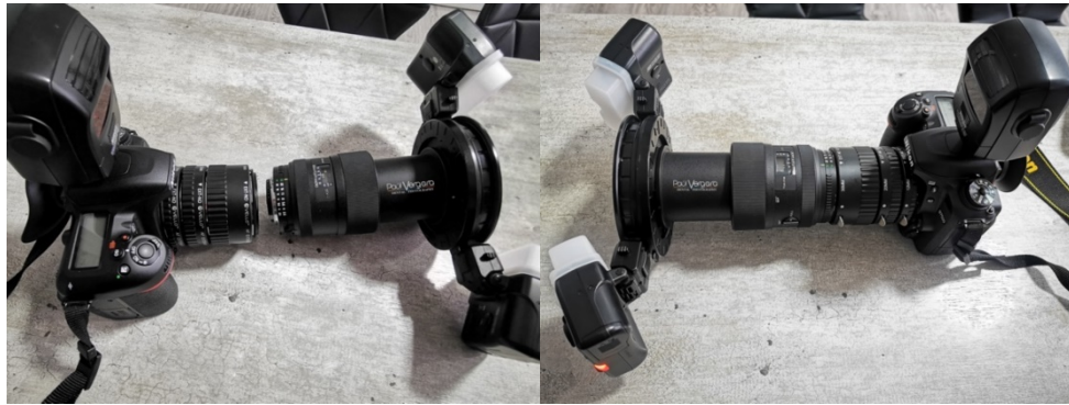
Figura 27. Colocación de los tubos extensores antes del objetivo. Fuente: Repositorio fotográfico Paúl Vergara
