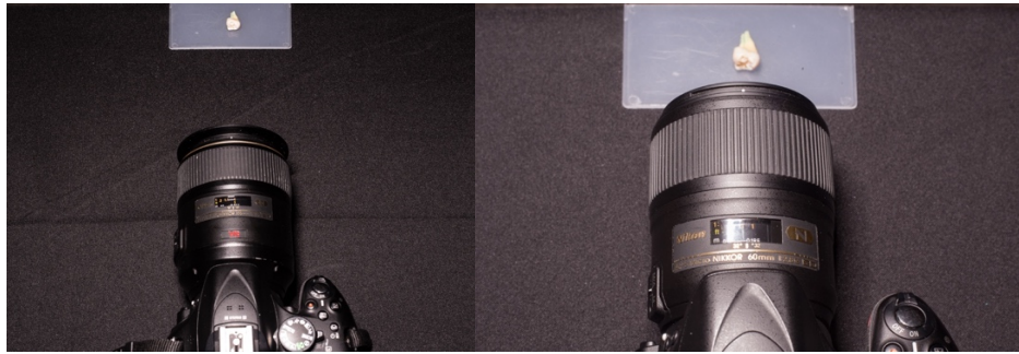
Figura 21. Nivel de acercamiento entre un objetivo de 105 mm (imagen izquierda) y otro de 60mm (imagen derecha) en una proporción 1:1 Fuente: Repositorio fotográfico Paúl Vergara.
