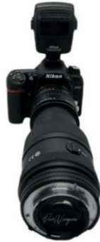
Figura 32. Lente colocado a la inversa sobre el anillo inversor Fuente: Repositorio fotográfico Paúl Vergara
