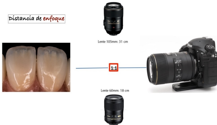
Figura 19. Ilustración de la distancia de enfoque en lentes de 105mm y 60mm con relación de aumento 1:1. Nótese la distinta distancia en centímetros que se requiere con cada lente.
