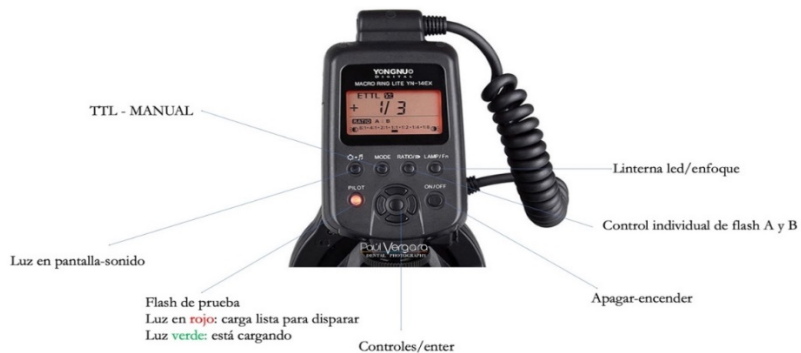
Figura 38. Partes del panel de control del ring flash Fuente: Repositorio fotográfico Paúl Vergara
